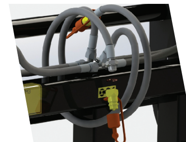
Быстроразъемные соединения гидравлики
